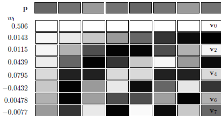
Figura 4.38: Una representación gráfica de la DCT unidimensional.
