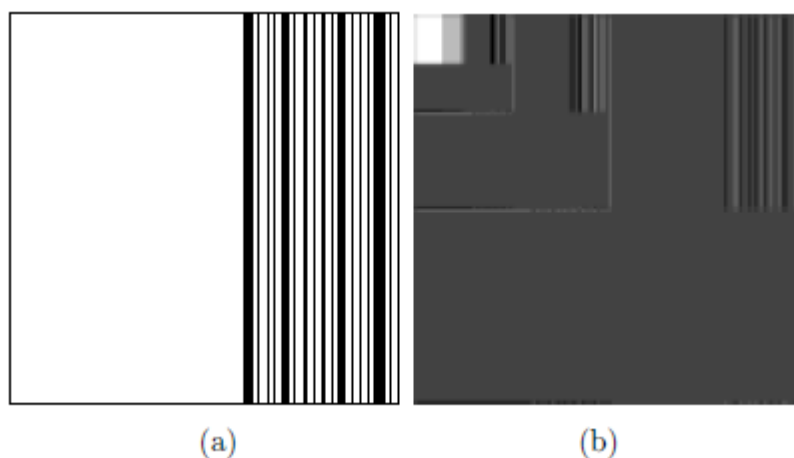
Figura 5.19: (a) Una imagen de 128 \times 128 con actividad en la derecha. (b) Su transformada.
